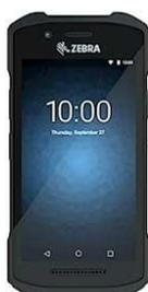
Il est paramétrable et permet de réaliser rapidement et facilement un large éventail de collectes de données : réceptions de commandes, inventaires, entrée, sorties, ... à base de codes-barres, en limitant les saisies et les erreurs. Il existe en version **Base** et **Pro**.
